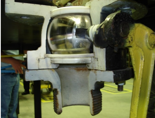
Vue en coupe d'un robinet à tournant sphérique
