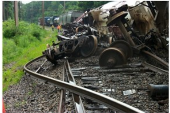
Les rails tordus ou sous contrainte
