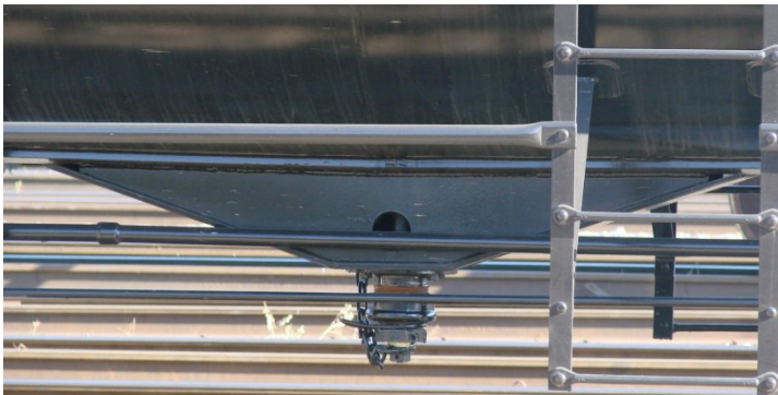
Robinet de vidange par le bas, dispositif ventral de protection – vue externe
